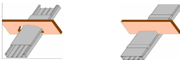
Figura 66 - Paso de canal a través de suelo
