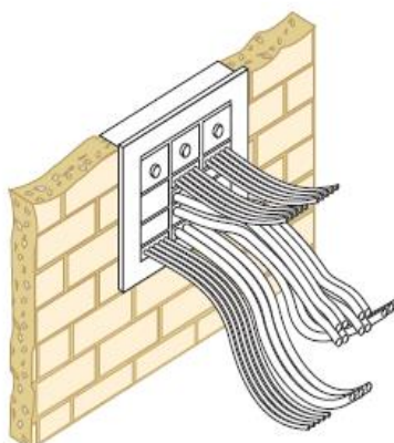
Figura 58 - Montaje de cableados a través de pared con pasamuros
